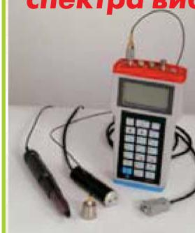
Прибор для измерения и спектрального анализа параметров вибрации, балансировки, ремонта и наладки механизмов роторного типа.
