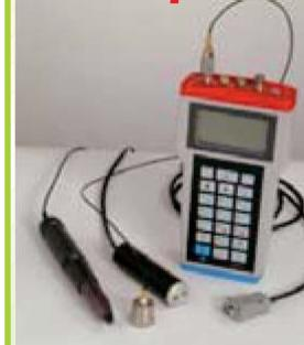
прибор для измерения и спектрального анализа параметров вибрации, балансировки, ремонта и наладки механизмов роторного типа.
